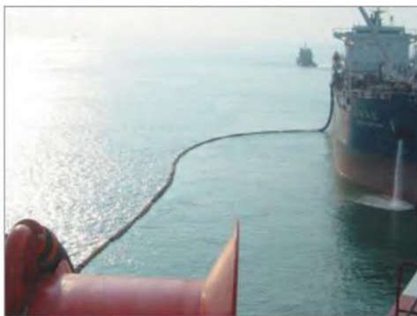
输油管线完全展开的情况
