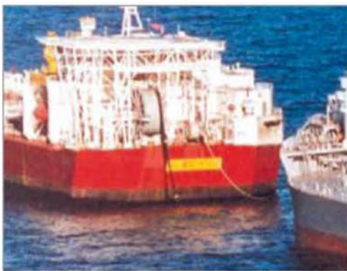
FPSO 油轮船尾管线轴出口
